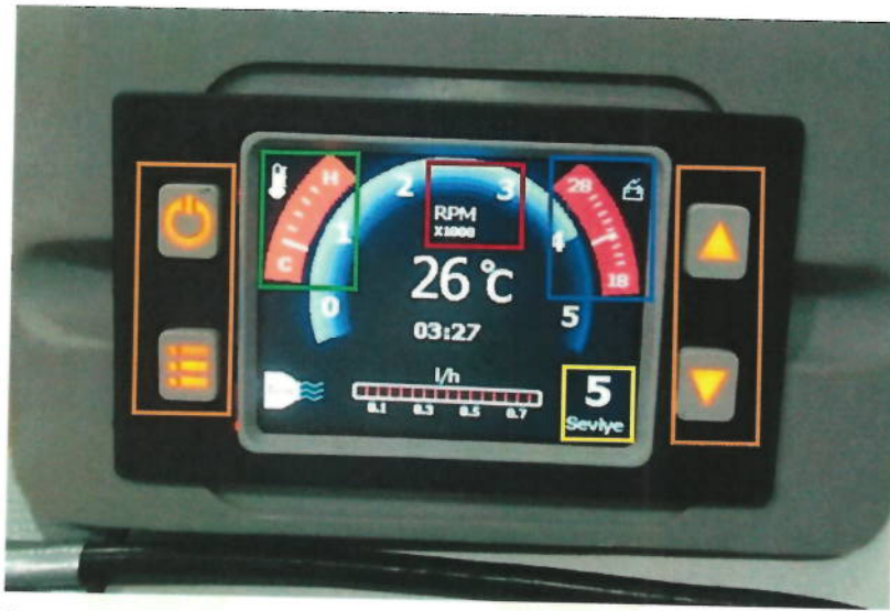
Şekil 8. Her iki cihaz için performansın izleneceği, Kontrol Ünitesi ekran görüntüsü ve butonlar
