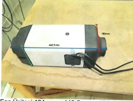
Fan Ünitesi: 164 mm x 442,5 mm x 183 mm
